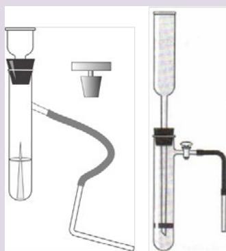
Рис. 7. Прибор для получения и собирания газов
