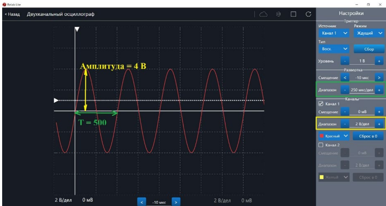
Рис. 42. Определение параметров осциллограммы
